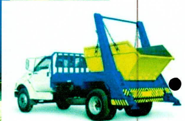
Caminhão Poli-Guindaste para recolhimento de entulhos. Marca Ford F14000.
