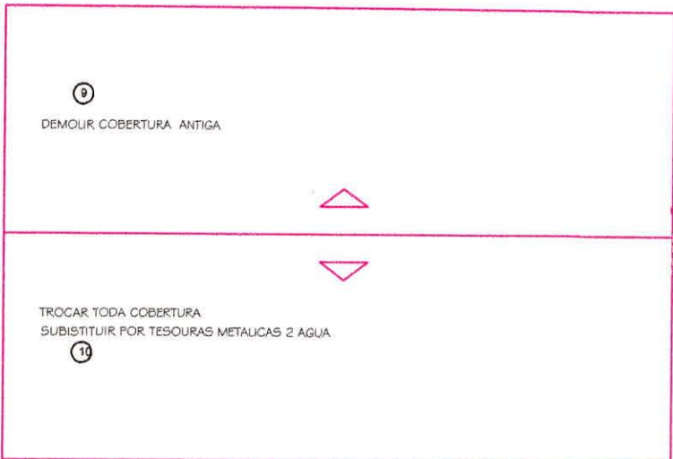
PLANTA COBERTURA Escala: 1/100 AREA: DE 638m² RETRAIÇÃO EXISTENTE E REFAZER COM TESOURAS METALICAS 2 AGUAS
