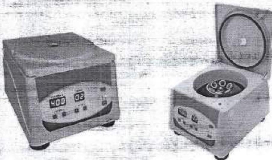
**Centrifuga Digital com tubos de 6x15ml e adaptadores para tubos de 5ml DT 4000 - Daiki**
